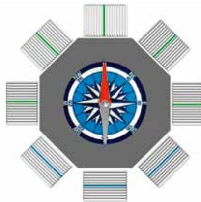
■ E-NE-N-NO-O: lames perpendiculaires au mur.
